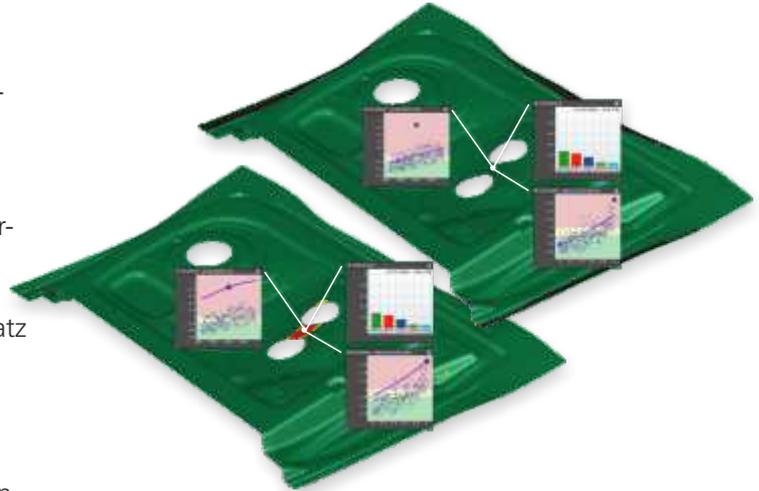
**Die Designparameter, die den größten Einfluss auf das erzeugte Bauteil haben, können während des Werkzeug- und Prozessdesigns identifiziert werden.**
