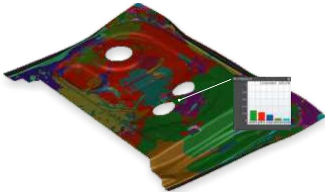
**AutoForm-Sigma bietet Transparenz für den Umformprozess, indem es anzeigt, welche Parameter die Bauteilqualität beeinflussen und in welchem Ausmaß.**
