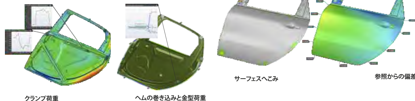
クランプ荷重 ヘムの巻き込みと金型荷重 サーフェスへこみ 参照からの偏差
